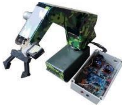
Gambar 4. Realisasi Perangkat Keras Robot Lengan 6 Derajat Kebebasan
