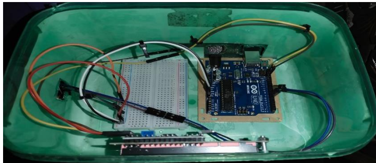
Gambar 3. 2 Alat pengukur tinggi tubuh otomatis setelah dirangkai
