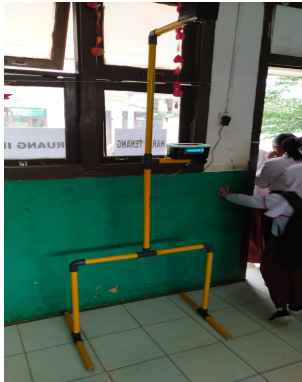
Gambar 3.5 Bentuk alat pengukur tinggi tubuh otomatis
