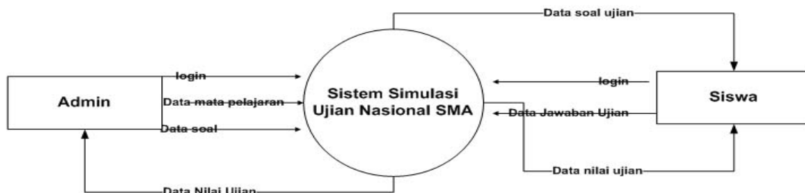
Gambar 2. Context Diagram Sistem Simulasi Ujian Nasional SMA
